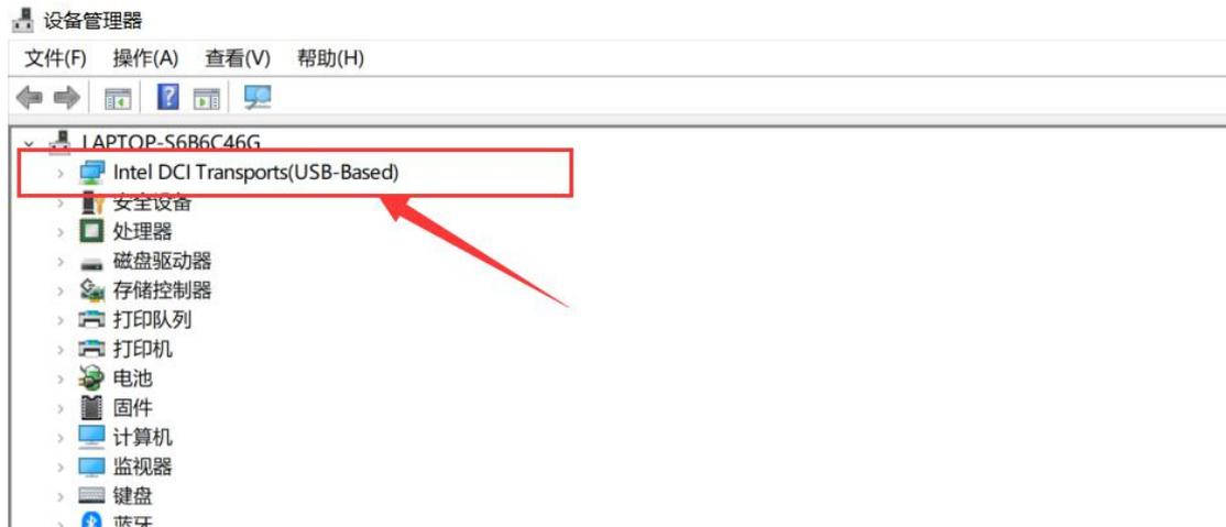
如果没有找到 DCI 设备，那么请展开 USB 控制器的子设备，如果发现类似下图所示的 Unknown USB Device，那么右键点击这个设备，先选 Disable，再选 Enable
